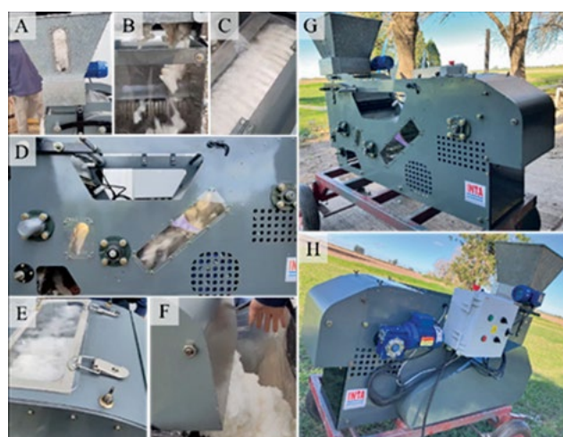
Figura 7. Imágenes de la máquina final en funcionamiento. Ingreso del algodón bruto en el cargador (A), visor posterior donde se evidencia la caída del algodón bruto al sistema de sierras (B), proceso de desmote (C), visores laterales donde se observa el pasar de la fibra desmotada (D), visor de la parte superior del condensador (E) y salida de la fibra neta por la parte frontal (F). Vistas laterales de la mini desmotadora finalizada (G-H).
